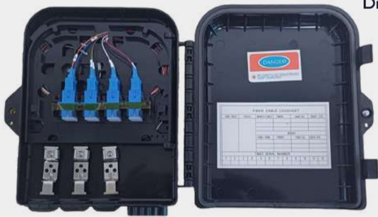
Caja NAP 8 puertos SC/UPC CON 1 SPLITTER 1*8 LGX
